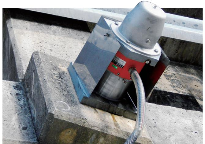
アンカー緊張力の面的分布調査結果を基にモニタリング箇所を選定を行えます。また、のり面状況に合わせてモニタリング箇所の変更を簡便に行えます。
