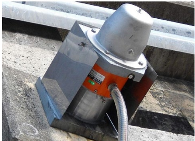
図 1-2 SAAM-L の構成と後付け荷重計設置状況（写真）
