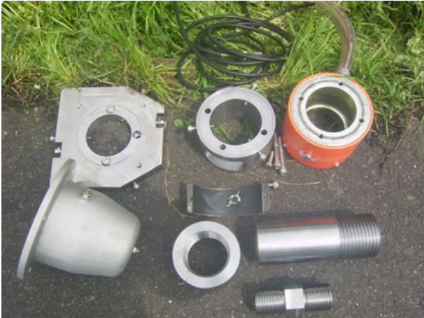
図 1-2 SAAM-L の構成と後付け荷重計設置状況（写真）
