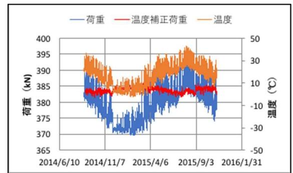
図 5.5.5 実測荷重と温度補正荷重
