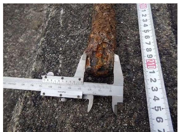
写真 2.2.4 テンドン破断の例(左:外力破断・右:劣化(腐食)破断)
