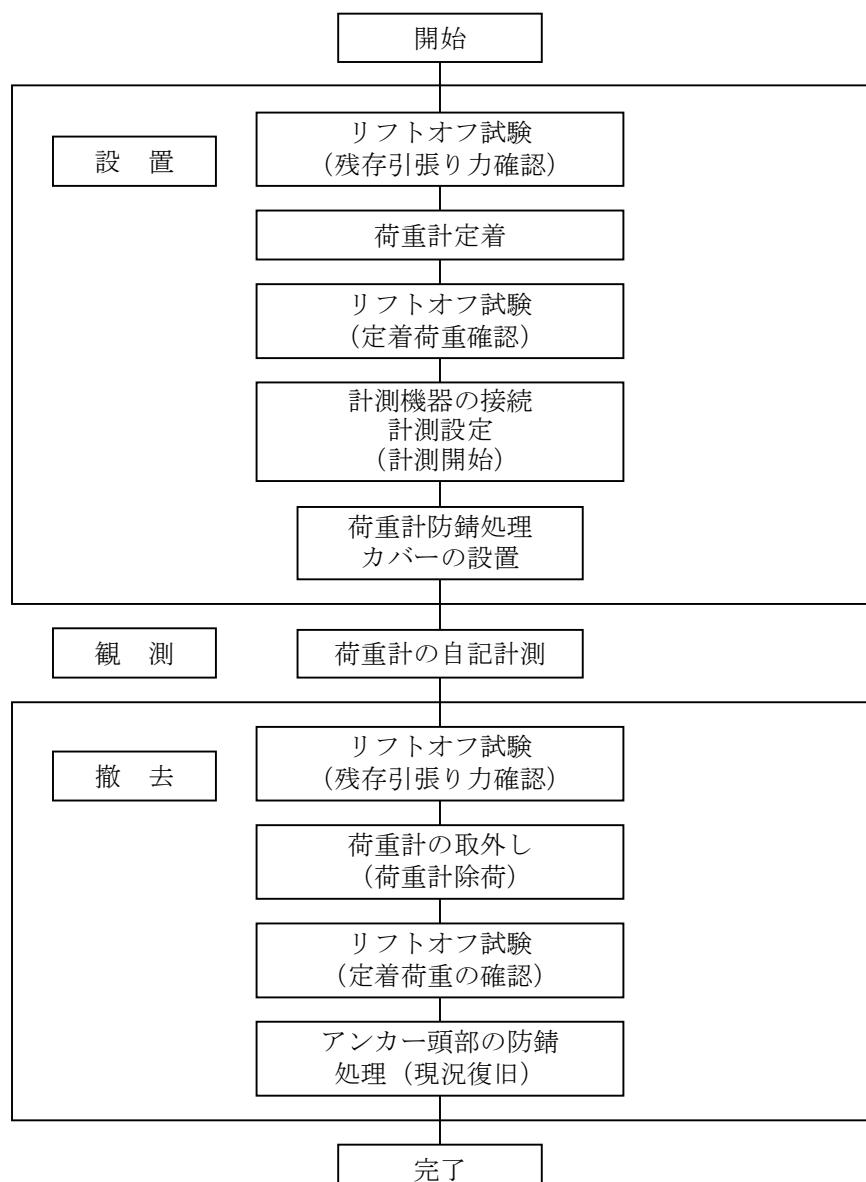
図 4.4.3 後付け荷重計の設置・撤去作業フロー図
