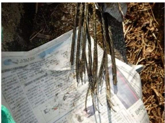
写真 4.4.9 テンドン破断箇所
