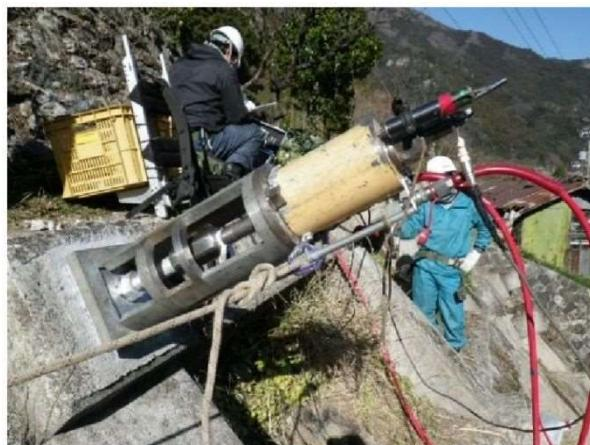
写真 4.4.4 ジャッキによる抜き取り調査
