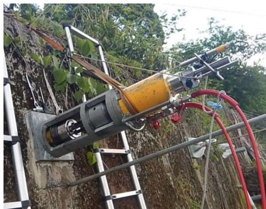
図 4.4.26 リフトオフ試験(アンカー耐力確認)装置の例
