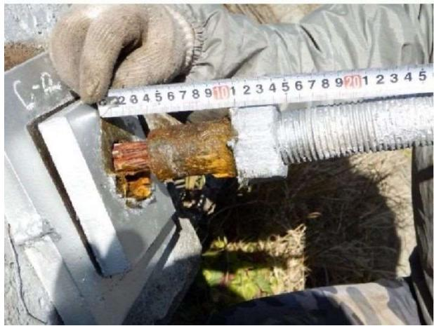
写真 4.4.5 ジャッキによる引抜け後
