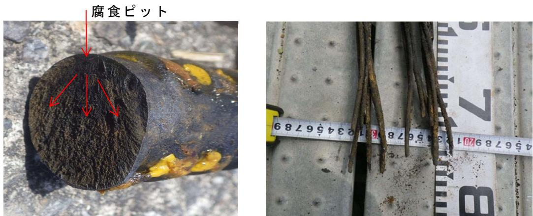
参考写真 4.4.1 腐食破壊例 (左側：鋼棒タイプ例、右側：PC鋼より線タイプ)
