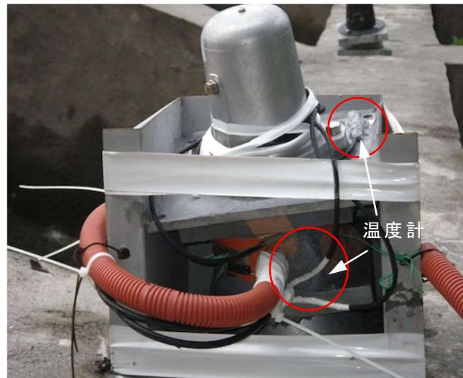
写真 4.4.1 温度計の設置例
