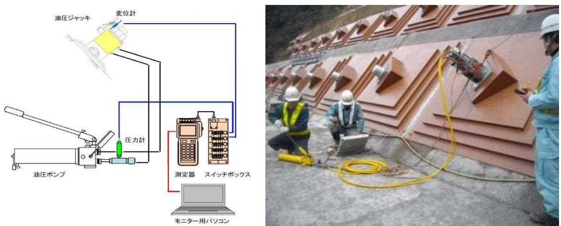
図 3.6.1 残存引張り力確認試験状況(例)
