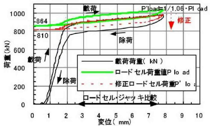
図 1-3 既設荷重計の簡易検定
