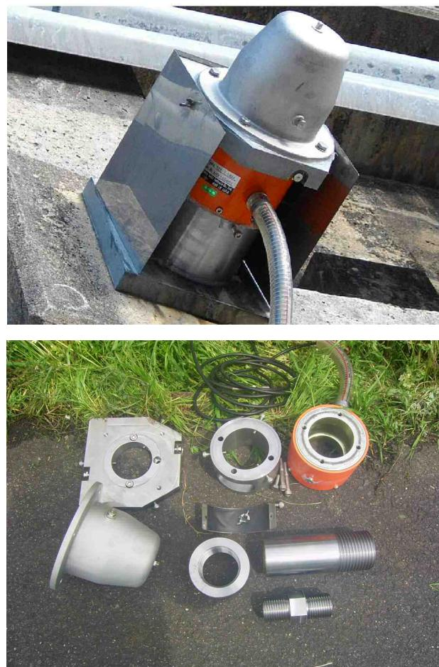
図 1-2 後付け荷重計 (SAAM-L)
