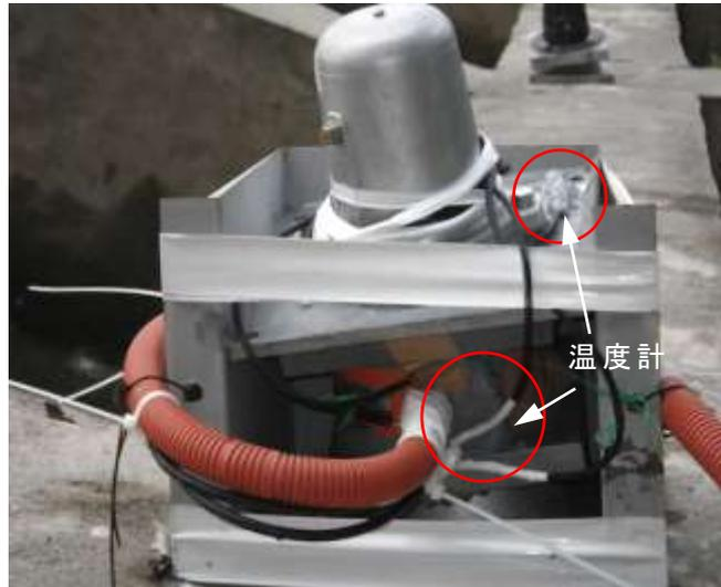
写真 4.4.1 温度計の設置例
