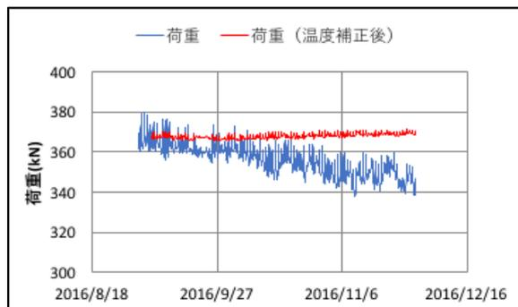
図 5.4.2 実測荷重と温度補正荷重
