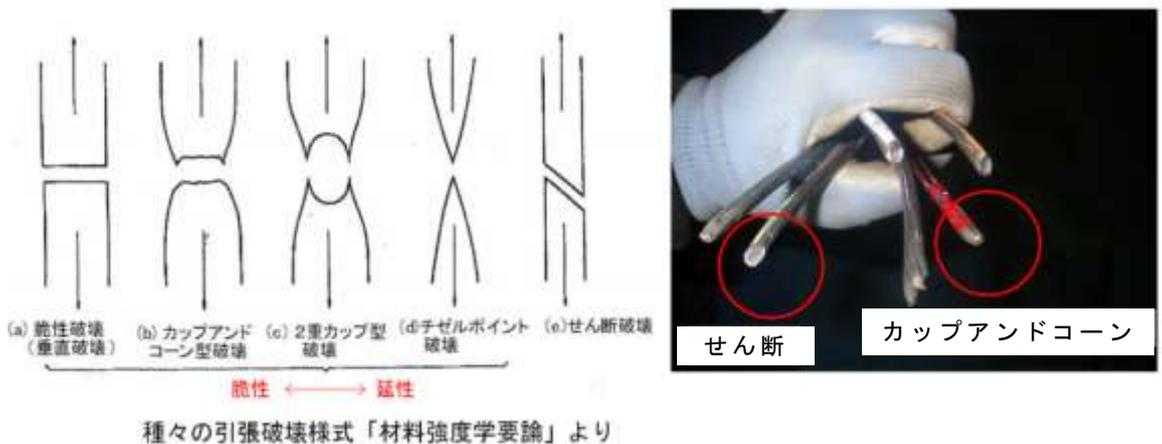
参考図 4.4.1 鋼材の破断面形状
