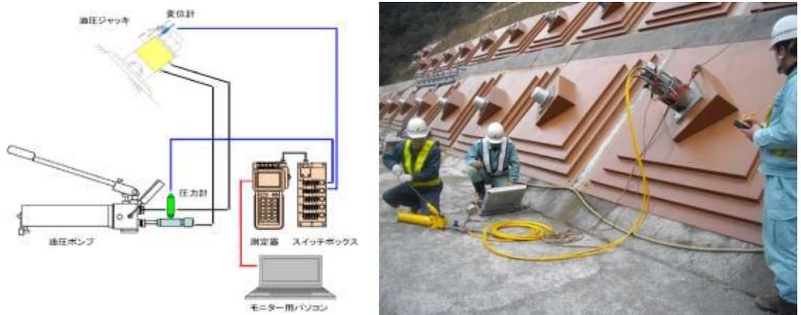
図 3.6.1 残存引張り力確認試験状況(例)
