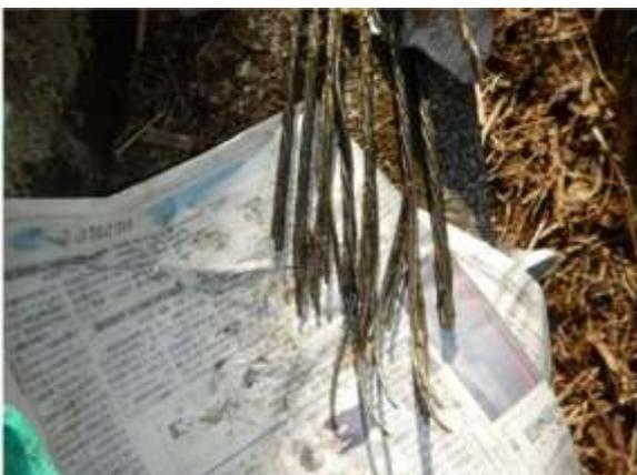
写真 4.4.9 tendon 破断箇所
