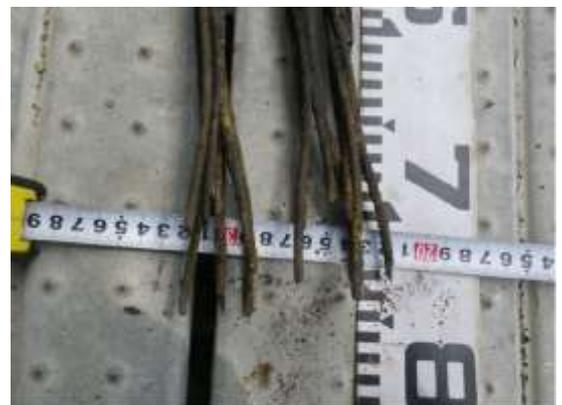
参考写真 4.4.1 腐食破断例 (左側：鋼棒タイプ例，右側：PC 鋼より線タイプ)
