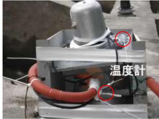
写真 5.2.1 温度計設置位置アンカー荷重と温度の相関
